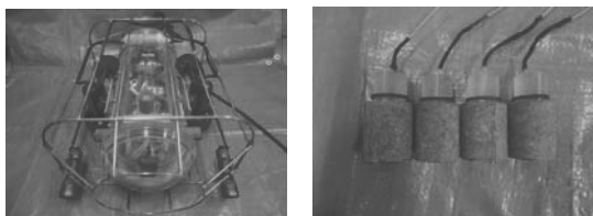
図3 4チャンネルソナー取付図と送受波器
