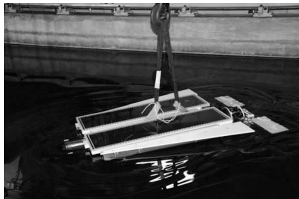
Fig.2 Tonai60 のグライディング試験 (深海機器力学実験水槽にて)
