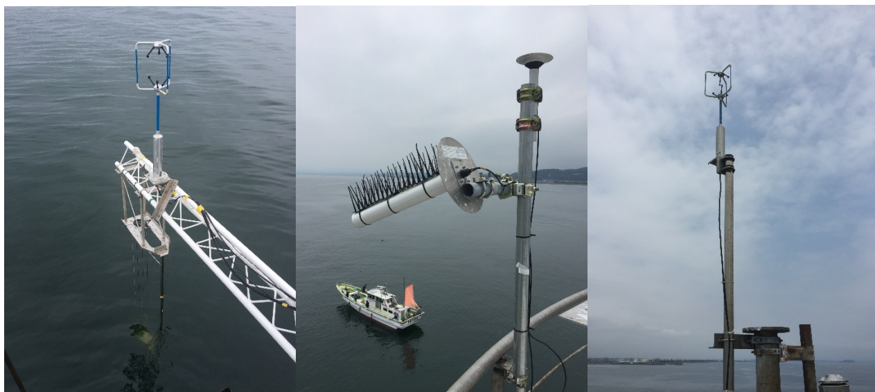
図： 左から、平塚塔に設置した波浪計アウトリガーと風速計、屋上に設置した GNSS-R 受信アンテナ、屋上に設置した風速計
