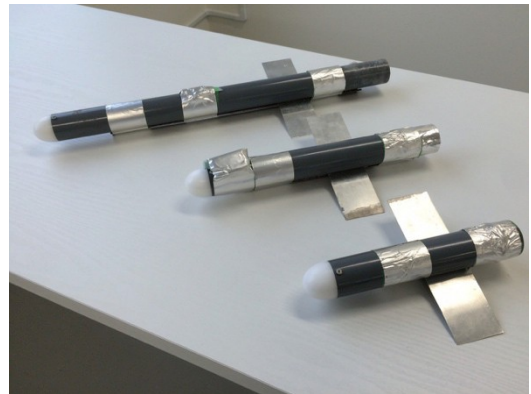
Fig.3 密度差エンジン水中グライダー試作機
