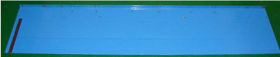
Si-Polyurea (roughness~30 \mu m)
