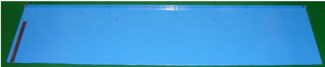
Si-Polyurea (roughness~47 \mu m)
