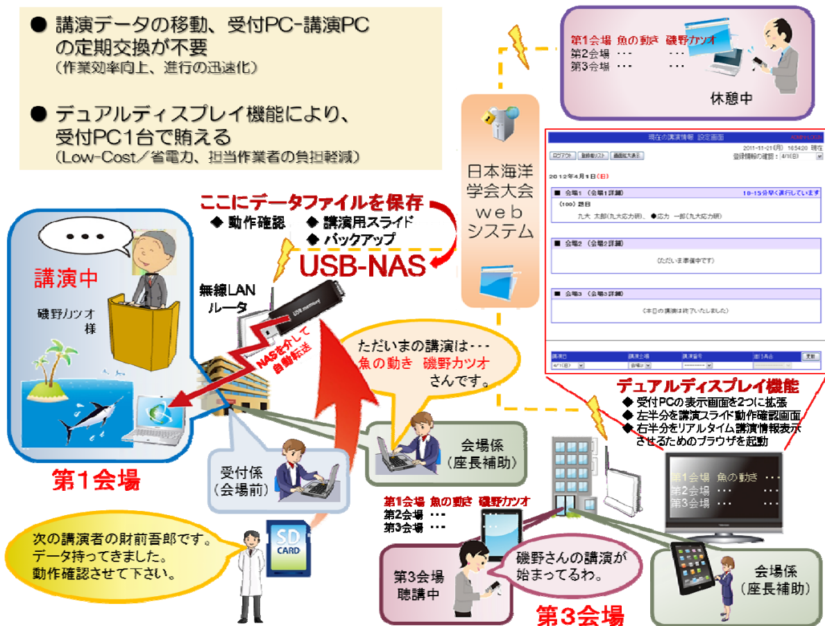
講演情報リアルタイム表示システムおよびUSB-NAS を介した講演ファイル自動転送/同期システムをネットワーク統合した大会運用例 (イメージ図)
