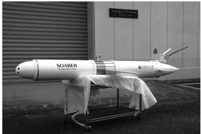
Fig.1 主翼独立制御型水中グライダー SOARER
