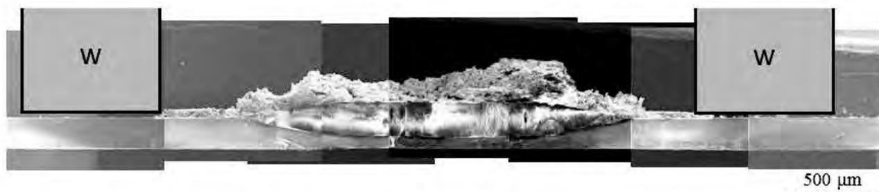
図2 3SG 法により成長させた厚膜結晶の断面 SEM 写真。W (タングステン) は坩堝材の位置を示す。
