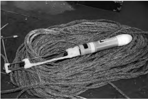
Fig. 6 Acoustic data logger, A-tag.
