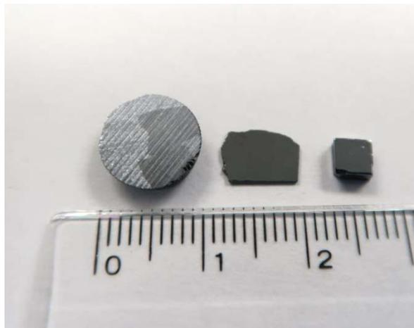
Fig. 2 Na-doped CZTS 単結晶サンプル
