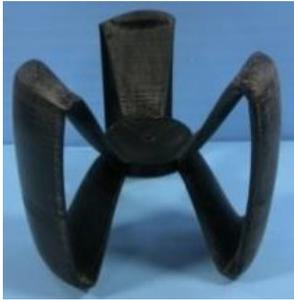
図1 ミニチュアバタフライ風車モデル( $D = 80$  mm,  $d = 30$  mm)
