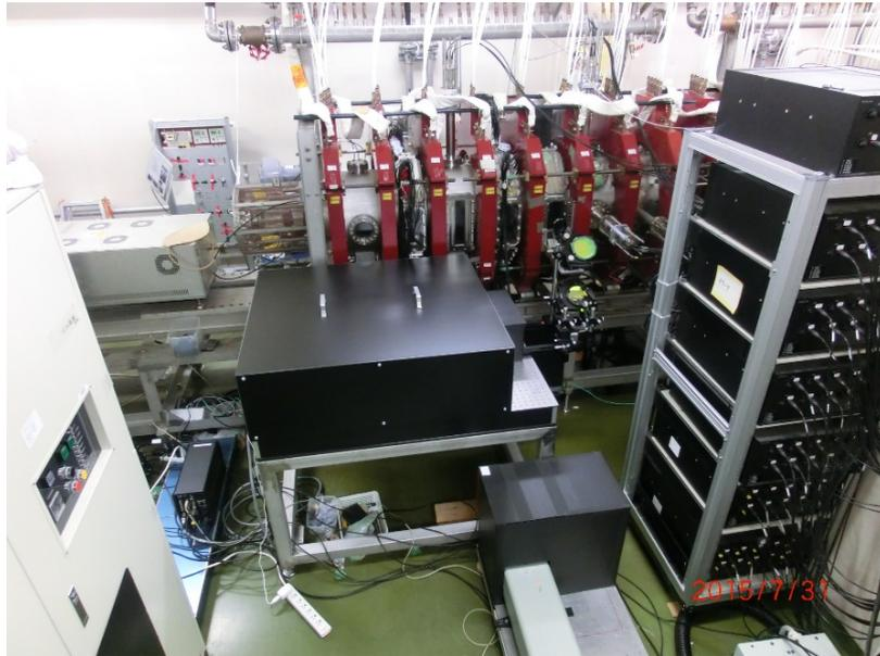
図3. トムソン散乱システム導入後の PANTA 装置周辺写真。プローブレザーのレーザーヘッドは写真下。レーザーは暗箱を通り、PANTA 装置した側に設置されたミラーおよび集光レンズを通り、チャンバー中心軸上で集光され、その後チャンバー上側のビームダンパーに導かれる。トムソン散乱光の一部は、PANTA チャンバー横の窓からレンズで受光され、分光器内に導かれた。
