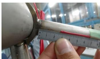
図 2 マルチロータ型レンズ風車へのひずみゲージ取り付け
