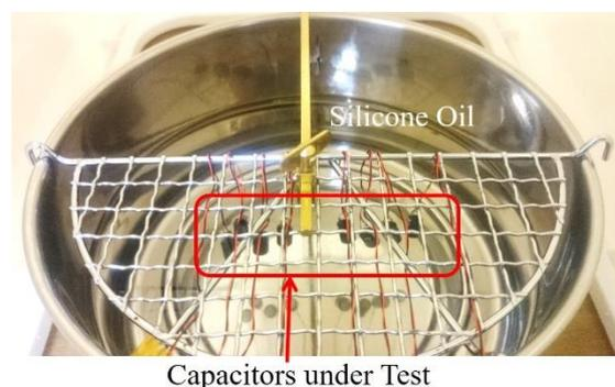
図 2 オイルバスを用いた加速試験
