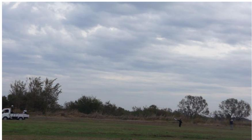
Fig. 1 妻沼グライダー滑空場におけるフィールドテスト：左端の車で中央で手に持っている風車を引いて風で上空に揚げる (2017年 11月 12-15日)
