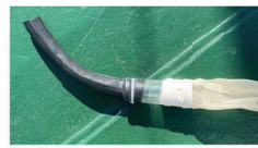
自転車のチューブで補修して使用しているコットエンド
