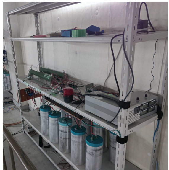
図2 PLATO 装置の垂直磁場用コンデンサバンク
