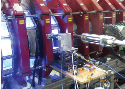
図1：PANTA装置に設置したX-band フェーズドアレイアンテナと周波数コムとを組合せた新開発ドップラーレーダー装置。
