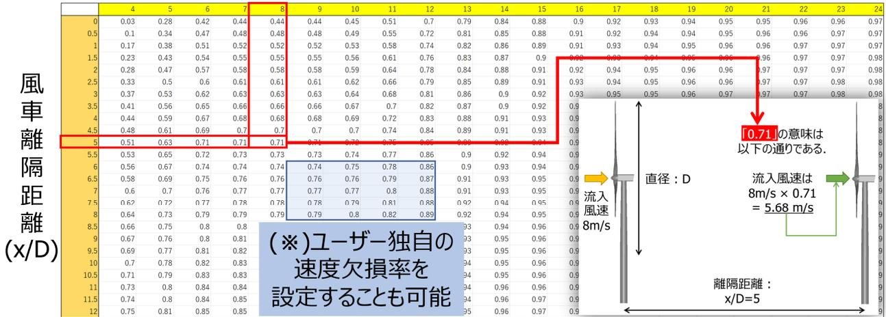
図10 RC-Scopeで作成したルックアップテーブルの例
