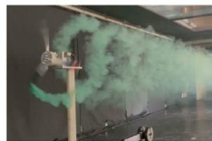
図2 浮体式風車ウエイク現象の可視化
