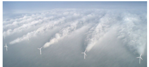
(a)実際の風車群のウェイク(後流域)が霧で可視化された事例
