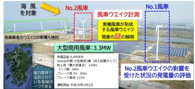
(a)A-STEPで研究対象としている北九州市響灘地区の大型風車
