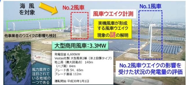
(a)A-STEPで研究対象としている北九州市響灘地区の大型風車
