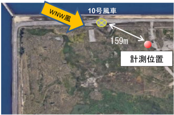
図1 ウエイク計測位置
