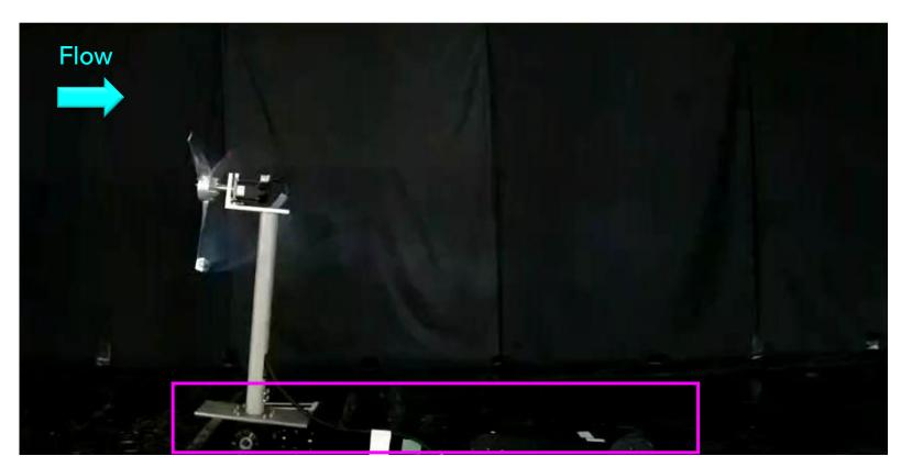
加振装置製作し、浮体の動揺(ピッチ運動)を再現
