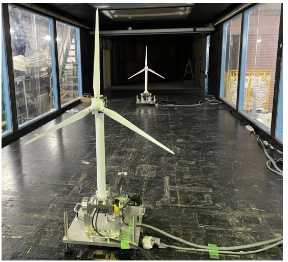
本PJで製作した15MW風車模型 (1/240)と加振装置
