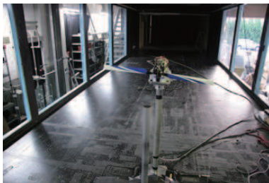
タワーシャドウ効果と独立ピッチ制御の風洞試験
