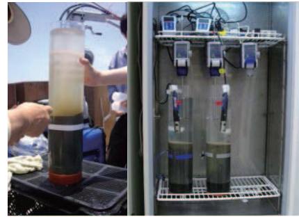
諫早湾での底泥コアの採取と酸素消費実験
