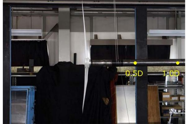
図8 風車後流の流速測定点の例
