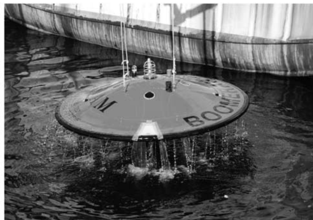
浮力調整試験中の改良型ブーイ
