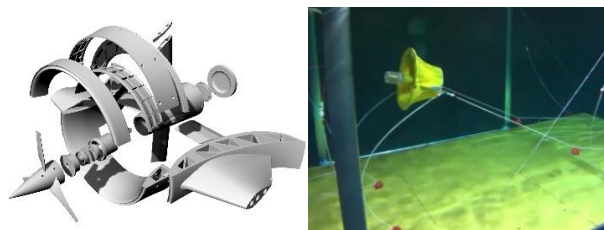
新型浮遊式潮流発電装置の設計と模型試験 (潮流発電システムおよび係留装置、特願2017-224776)
