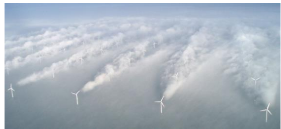
(a)実際の風車群のウエイク(後流域)が霧で可視化された事例
