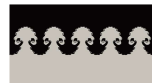
FR 法によるレイリー・テイラー不安定の数値シミュレーション Rayleigh-Taylor instability by Flux Reconstruction method
