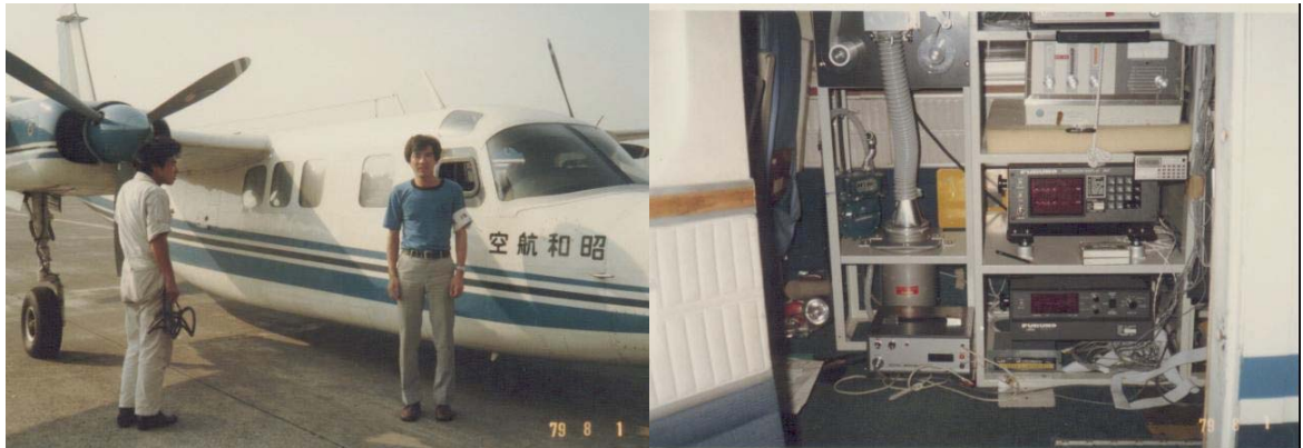
写真：航空機観測に使用した機体とテープエアサンプラー
