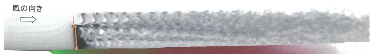
数値風況診断技術RIAM-COMPACTによる風車ウエイクの数値風況シミュレーションの例 (流れ方向の風速成分の分布図)
