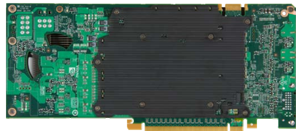
図2 本研究で使用したGPU, Tesla M2090 (512CUDAコア, 6GBメモリ) x 4枚
