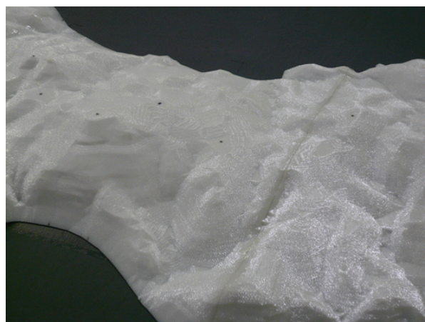
(b)凹凸なし縮尺模型, ポリカーボネートより作成 図-10 縮尺模型の比較, 拡大図
