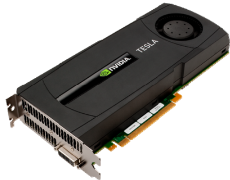
図2 本研究で使用したGPU, NVIDIA Tesla C2050 (3GBメモリ)
