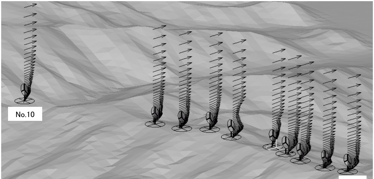
図5 各風車位置における速度ベクトルの鉛直分布, 北風の場合, 瞬間値
